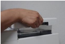
給水タンクを取り外す
