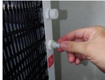
栓を取り付ける
