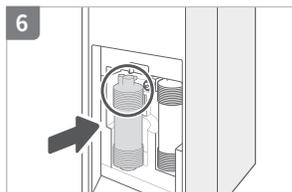
6 新しいフィルターの上部をつかみ、本体のフィルター接続部に平行に押し込んで取り付けます。
