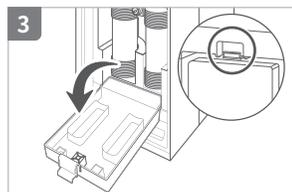
3 フィルターカバーのレバーを押して、カバーを開けます。
